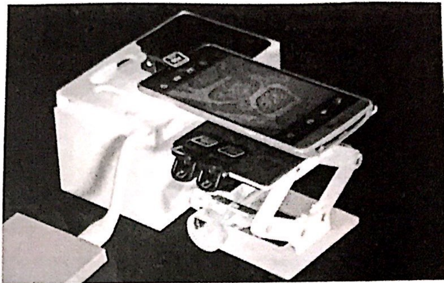
รูปที่ 1 กล้องจุลทรรศน์ดิจิทัลจากโทรศัพท์มือถือเก่า
